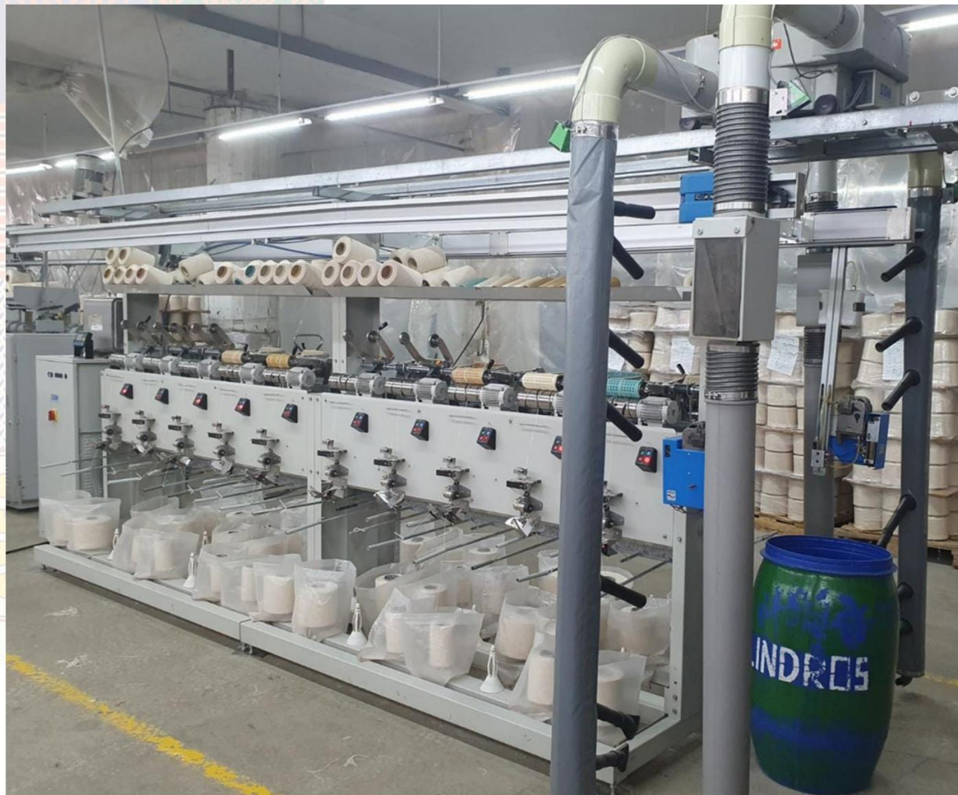
Mediante la adquisición y reemplazo de sensores dañados, y logrando la habilitación de varios cabezales, se incremento la producción en el primer trimestre llegando al 100% de su capacidad instalada (de 22,8 Tn/mes a 25,2 Tn/mes).
